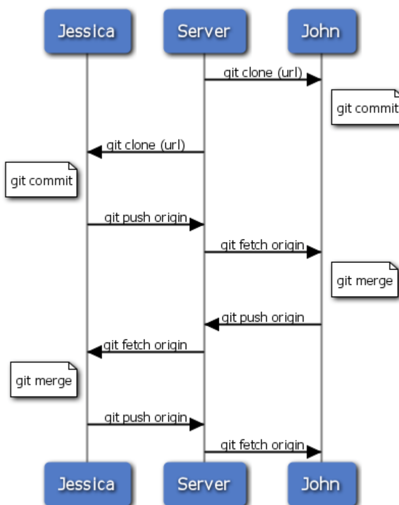
图 5-11. 多用户共享仓库协作方式的一般工作流程时序
